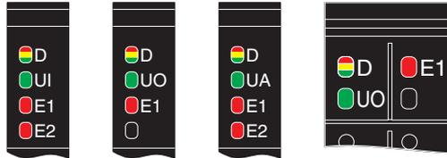
Bild 2-2 LEDs D und E auf den Einspeisesteckern der I/O-Module (Beispiele)
